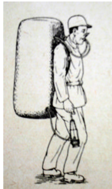
Selbstretter DRAEGER – Tübben Modell 1927 in geöffnetem Zustand
